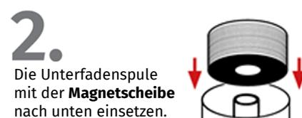
SPULEN MIT MAGNETISCHEN SEITENSCHLEIBE
